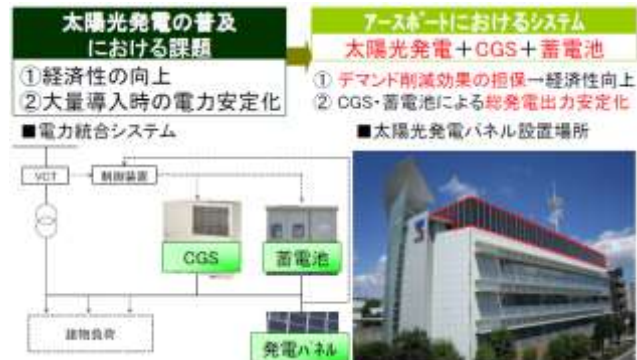
図-3 電力統合制御システム
