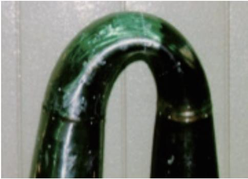
中圧都市ガス配管は、地震時の地盤変動の影響に耐えられるよう、強度や柔軟性に優れた素材が採用されており、180度曲げても破損しない（左図）。
