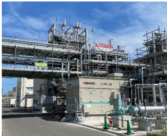
合成ガス製造 (逆シフト反応設備)
