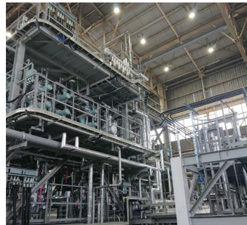
合成粗油製造 (FT合成反応設備)
