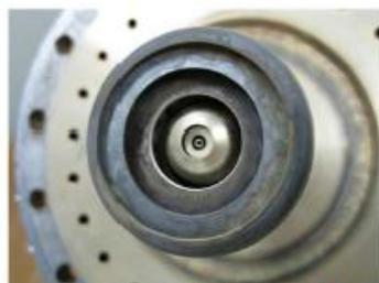
試験後の燃料噴射弁
