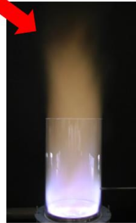
都市ガスのみ 都市ガス+アンモニア 火炎の比較（ガスタービン燃焼器）
