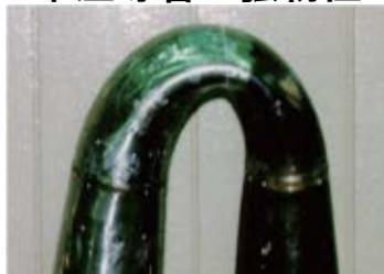
圧力の高い中圧 (0.1~1MPa) 都市ガス配管は、地震時の地盤変動に耐えられるよう強度や柔軟性に優れた素材が使用されており、180度曲げても破損しない。
