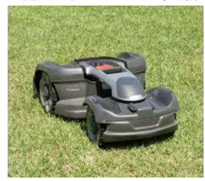
太陽光発電によるロボット草刈機
