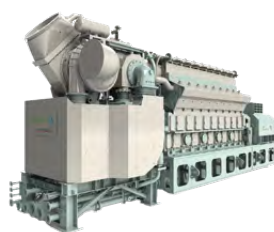
(上) 高効率ガスエンジンKG-18-Tをベースに開発したKG-18-T・HMエンジン。水素を30%まで混焼できる
