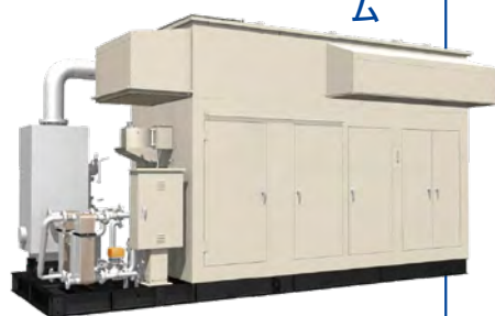
全国に約170台の導入実績を持つ「EP370G」をベースに開発した420kW級ガスコージェネシステム「EP420G」。従来品を上回る発電効率42.6%を実現した
